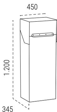
La boca del buzón incorpora una bandeja metálica abatible. Al abrir la tapa de boca, la bandeja se coloca en posición horizontal para recibir el paquete. Al cerrarla, ésta se desliza al interior del buzón.
