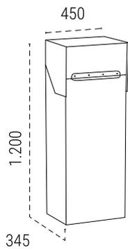
La boca del buzón queda hacia la calle y la puerta del buzón queda en el interior del muro de la vivienda, para poder extraer los paquetes desde dentro.
