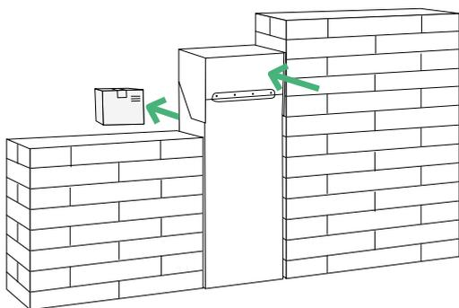
La boca del buzón incorpora una bandeja metálica abatible. Al abrir la tapa de boca, la bandeja se coloca en posición horizontal para recibir el paquete. Al cerrarla, éste se desliza al interior del buzón.
