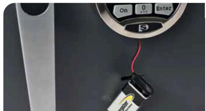
Alimentación mediante pila de 9V
